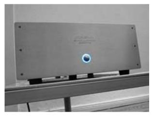
Ach ja, fast hätte ich's vergessen: Switchen lässt sich zwischen den Stand-by-Arten, indem man während des harten Einschaltens mit dem hinteren Netzschalter zugleich den vorderen Taster gedrückt hält.
